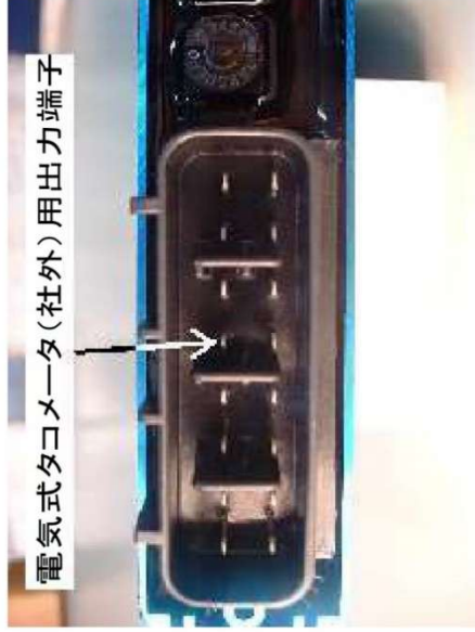
図8、SP2コントロールユニット、電気式タコメータ(社外)用出力線 (12Vデジタル、1パルス/回転)
