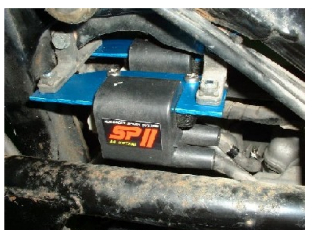
図6 SP2 イグニッションコイルの取付
