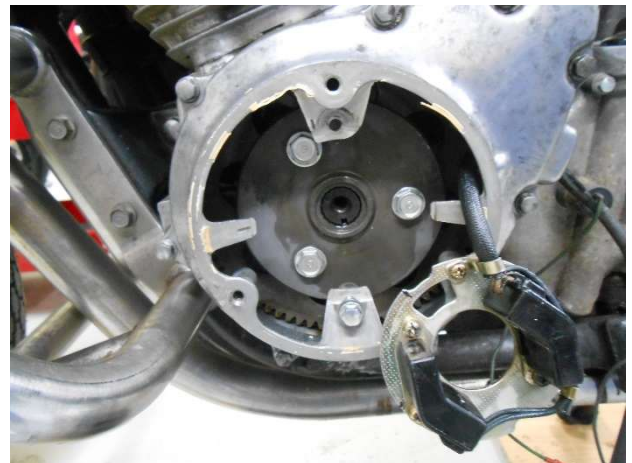
図2 パルスジェネレーター、ガバナ取り外し
