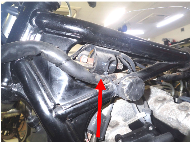
図1、ノーマルコイルの取り外し(4HM1～4HMD)
