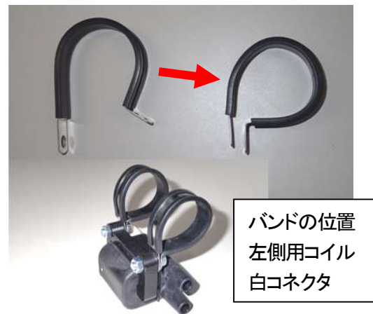
図4、コイルバンドの形を整える
