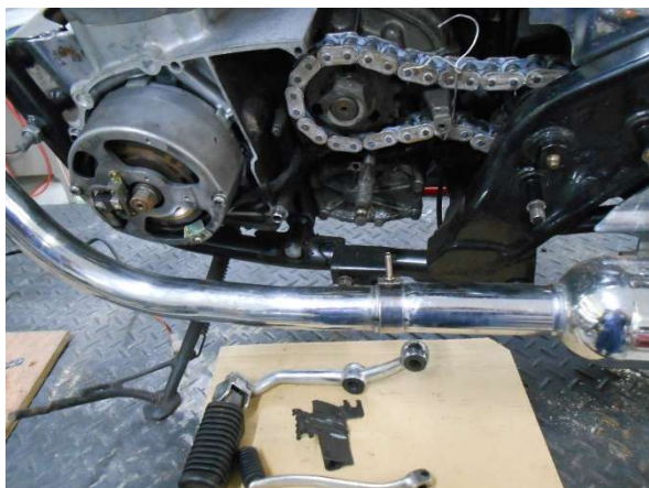
図1、ピックアップ他を外した状態
