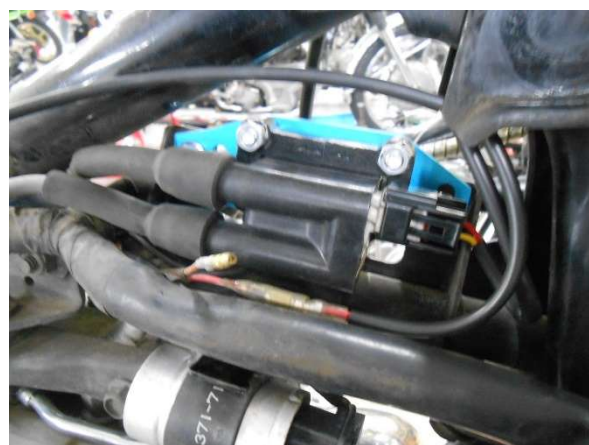
図3、SP2 コイルの取付
