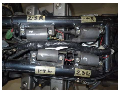
図5、コイル配置(数字はシリンダ、Lはシリンダの左、Rは右)
