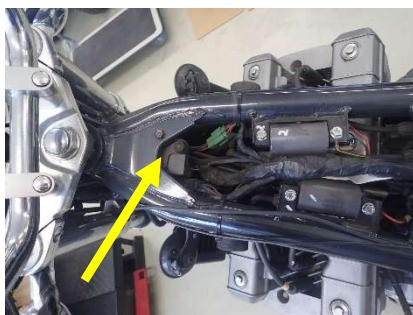
図2、ブーストセンサコネクタ3Pを外す
