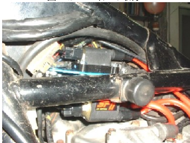
図2 SP2 コイルの取付
