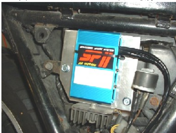
図1 SP2 コントロールユニットの取付
