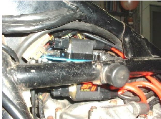
図4 SP2 コイルの取付
