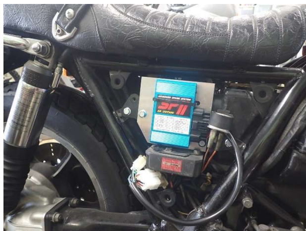
図2 SP2 コントロールユニットの取付
