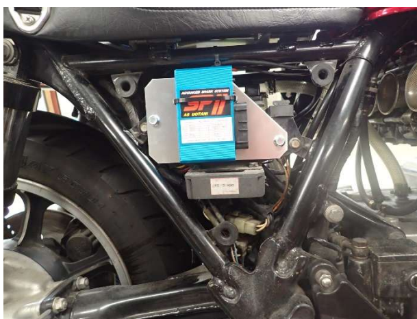
図2 SP2 コントロールユニットの取付
