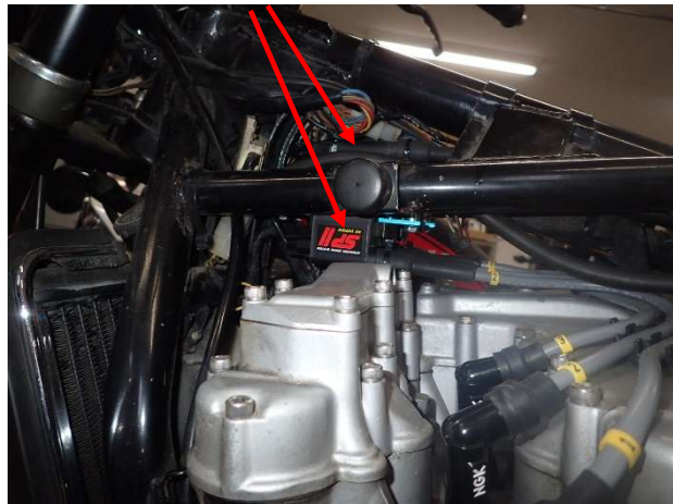
図4 SP2 コイルの取付
