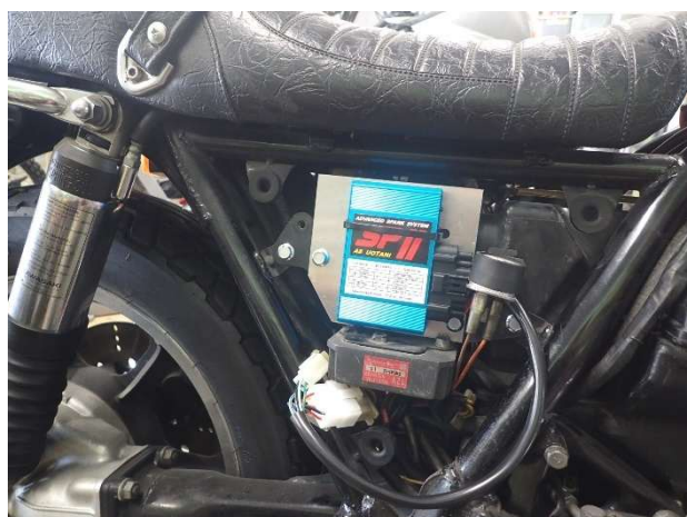
図2 SP2 コントロールユニットの取付
