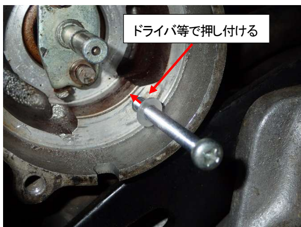
図5、スペーサ貼り付け時ボルト等を使用 すると貼り付けやすいです
