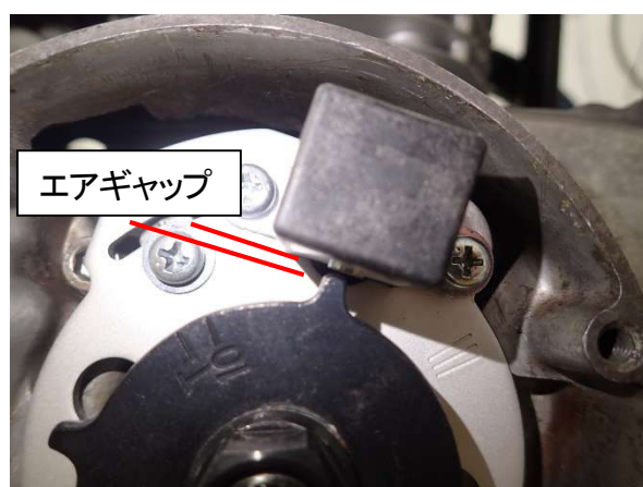
図5、エアギャップを0.4~0.6mmに合わせる
