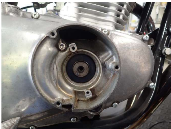
図1、ポイント／ガバナを外した状態
