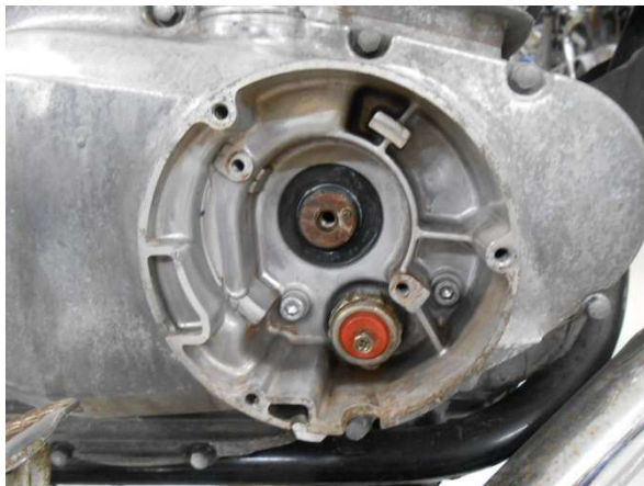
図1、ピックアップ(又はポイント)／ガバナを外した状態にしてSP2ピックアップASSYを取付ける
