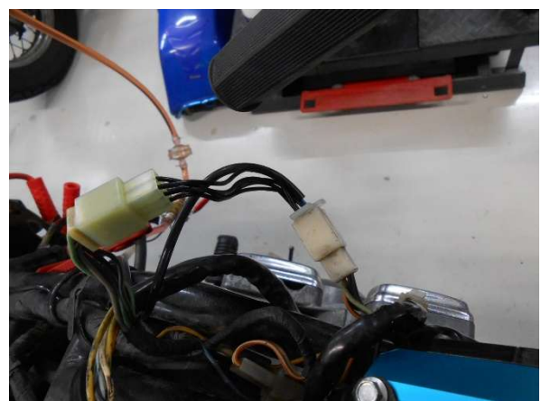
図6、オイルプレッシャースイッチ割込みコネクタの装着
