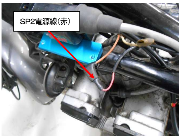
図5、電源接続、ノーマルコイルの電源線に接続(橙/白、左右どちらでも可)
