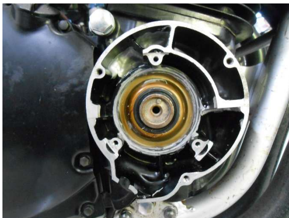
図1、ポイント／ガバナを外した状態
