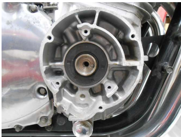
図1、ポイント／ガバナを外した状態
