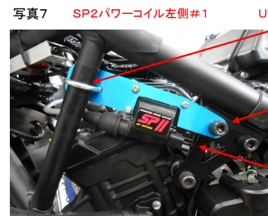
写真7 SP2 パワーコイル左側#1
