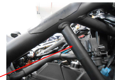
写真5,6 プロテクタゴムシートの貼り付け(左側も同様に)
