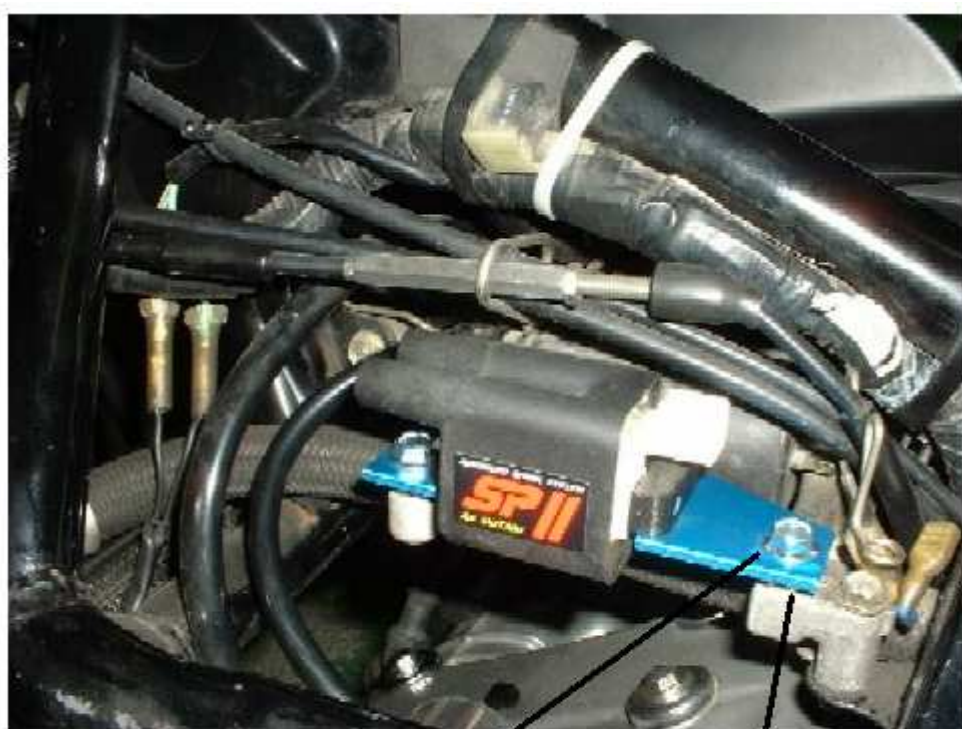
図 4 SP II コイルの取付け
