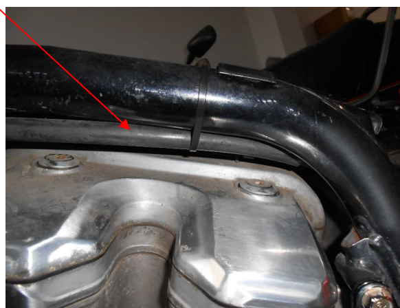
図4、図5、クラッチホースの取回し変更
