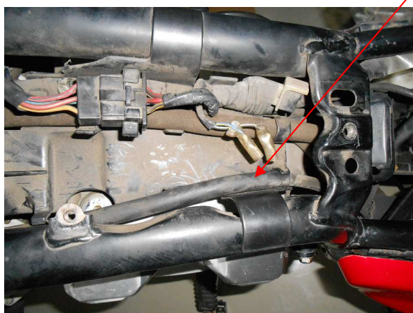
図4、図5、クラッチホースの取回し変更
