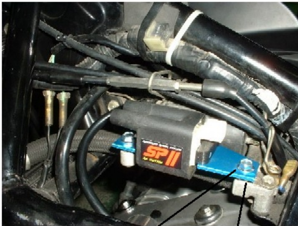
図 1 SP2 コイルの取付け
