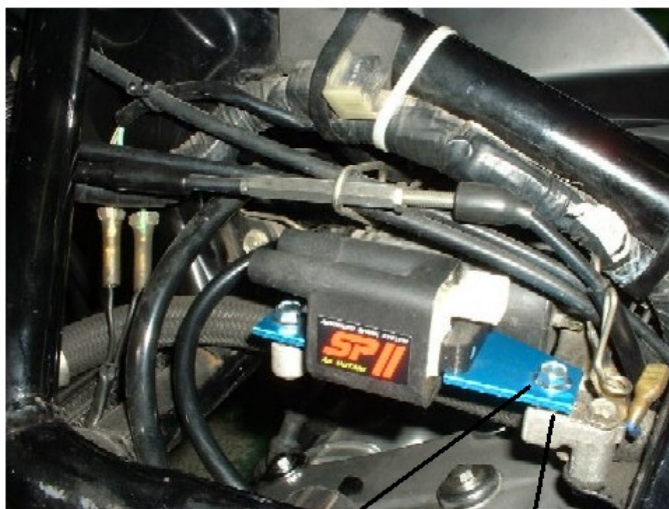
図 1 SP2 コイルの取付け
