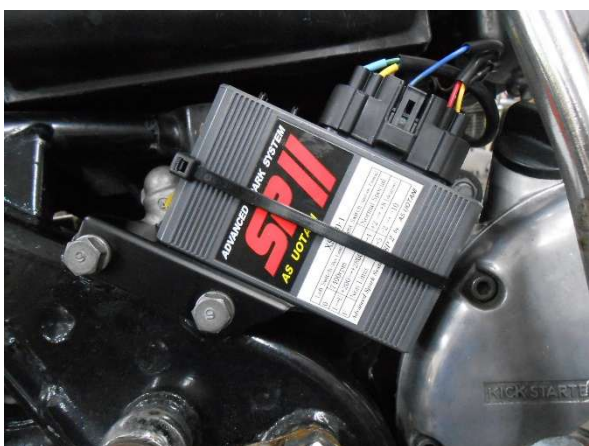
図5、コントロールユニットの固定
