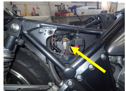
図3、ピックアップの2P黒コネクタを外す
