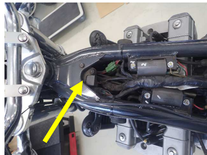
図2、ブーストセンサコネクタ3Pを外す
