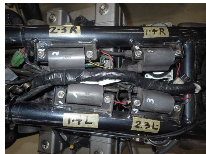
図5、コイル配置(数字はシリンダ、Lはシリンダの左、Rは右)
