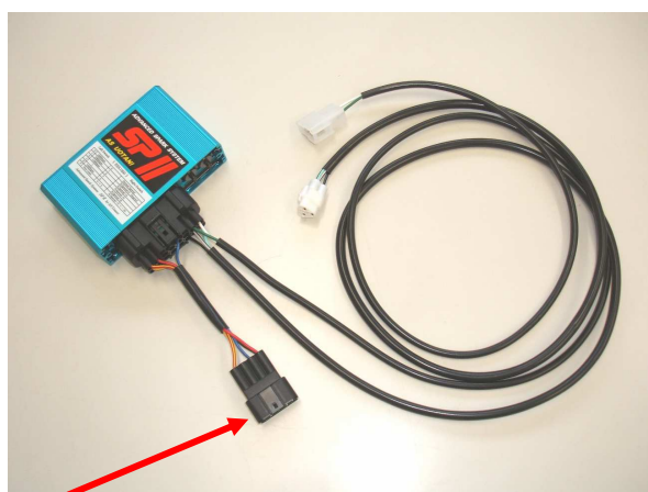
図2、ユニットハーネスを使用して接続する
