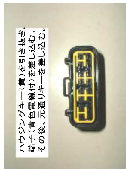
図9、SP IIコントロールユニット、電気式タコメータ(社外)出力線(12Vデジタル、1パルス/回転)
