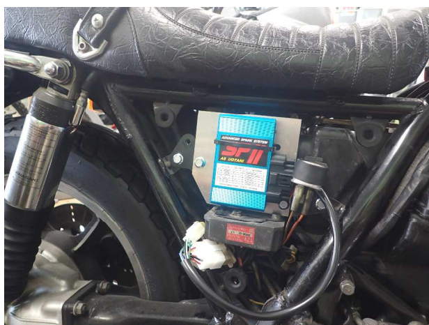
図2 SPⅡコントロールユニットの取付
