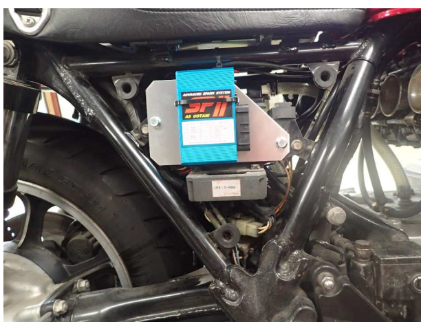
図2 SP II コントロールユニットの取付
