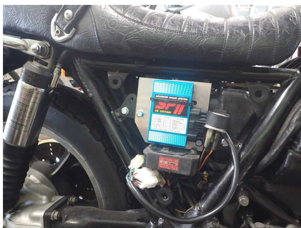
図2 SPⅡコントロールユニットの取付
