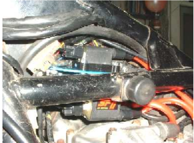
図4 SPⅡコイルの取付
