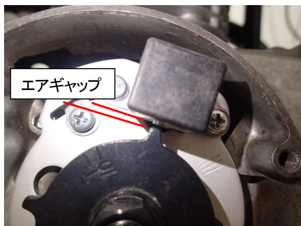
図5、エアギャップを0.4～0.6 mmに合わせる
