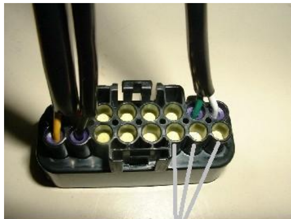
ダミー栓を引き抜く
