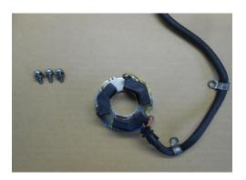
3、付属のキャップボルトとスペーサーを使用して ピックアッププレート に ピックアップASSYを 取り付ける。
