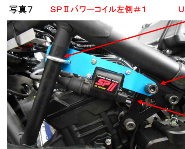
写真7 SPⅡパワーコイル左側#1
