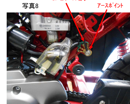
写真8: SP II アース端子の装着位置を示す写真。
