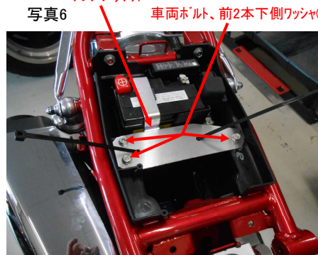
写真6: アンブブラケットの装着位置を示す写真。
