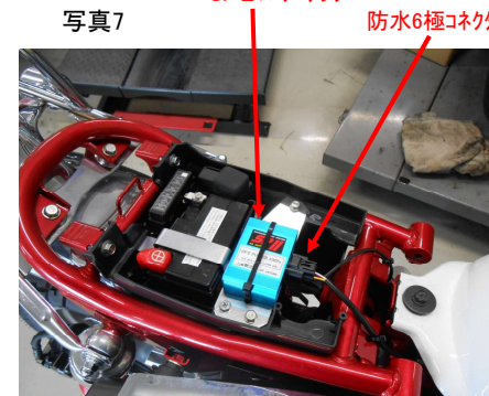
写真7: SP II パワーアンブの装着位置を示す写真。
