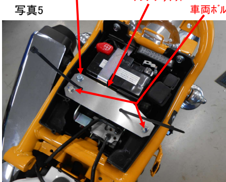
写真5: M6X25フランジボルト、下側12mmスペーサ (付属) の装着位置を示す写真。
